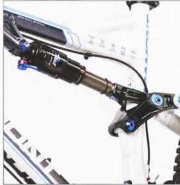
**2\_Federbein:** Das Fox Float RP2-Federbein ist 200 Millimeter lang und bietet extra Volumen. So ist es weniger progressiv. Die Plattformdämpfung hält den Hinterbau ruhig.
