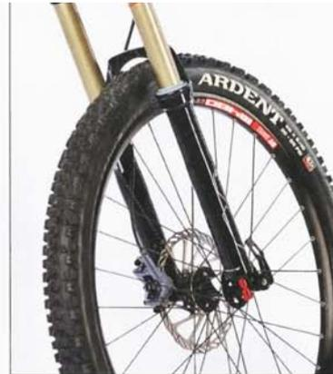
**3\_Absenkbare Gabel:** Die Rock Shox Revelation hat maximal 150 mm Federweg. Sie kann bis auf 120 abgesenkt werden.
