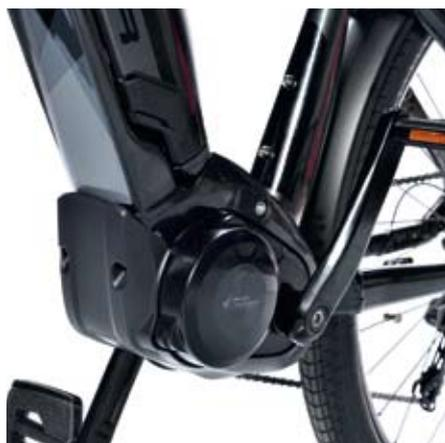
Der neue Panasonic Mittelmotor mit zweistufigem Getriebe.
