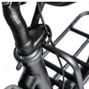
**Sinnvolles Detail: Der Vorbau lässt sich arretieren, was sicheres Beladen garantiert.**
