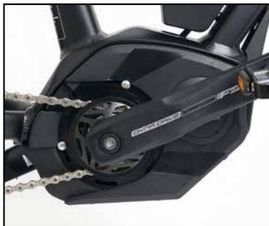
Der Bosch Performance Mittelmotor schiebt das E-Bike auch im Gelände nahezu geräuschlos an.
