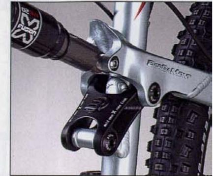
Eine steife Wippenkonstruktion trägt zum tollen Fahrverhalten bei.
