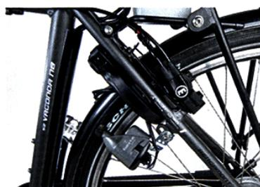
Alles Gute beieinander: Seitenläuferdynamo, Rahmenschloss fürs Kurzzeit-Verschleiß, Hydraulikbremsen, die auch im regenrischen Stadtverkehr sicher verzögern. Unten: Display des Bergamont, Wunsch aller Tester: Da Tasten sollten größer sein.
