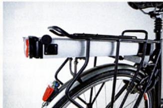
Der zum Promovec-Motor passende Akku unter dem Heckträger besitzt eine abgedeckte Außenladebuchse, lässt sich aber auch gut herausziehen.
