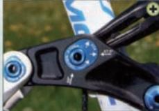
**Bergamont:** Mittels exzentrischen Einsatz in der Umlenkkippe lassen sich Lenk- und Sitzwinkel des Threesome um je 0,5° steiler stellen, um das Fahrverhalten auf winkligem Geläuf zu verbessern.
