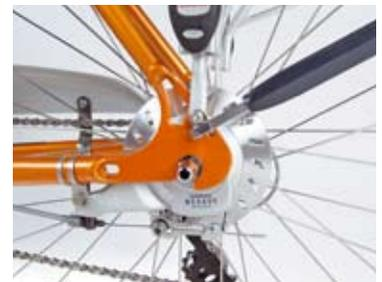
Gekapselte Trommelbremsen mit Lüfterscheibe zur Wärmeableitung
