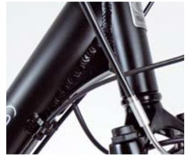
Zur Verstärkung: ein „Gusset“-Keil zwischen Steuer- und Hauptrohr
