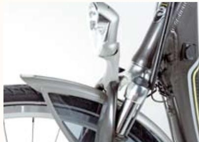
Tolle Details: Der Trelock-Scheinwerfer „wächst“ aus dem Federgabelkopf, Radschützer/Mantelschoner-Kombi sowie Ladebuchse für den Akku im Rahmen. Unten: Display, Schnellspannvorbau
