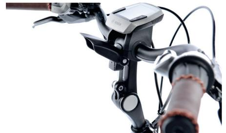
Der Vorbau kann am Batavus ohne Werkzeug schnell angepasst werden.
