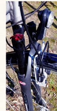
Links: Einstell- und blockierbare Federgabel, Hydraulikbremsen, Halogenlicht
