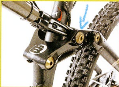
Die exzentrische Unterlegscheibe erlaubt eine Geometrieveränderung um 0,5 Grad.
