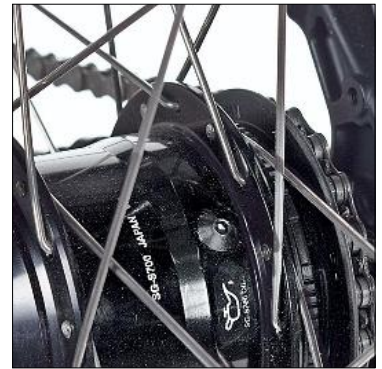
Daran sollt Ihr sie erkennen: Eine Ablassschraube und ein Ölkännchen weisen auf die neue Ölbad-Schmierung der Alfine 11 hin. Und auf den empfohlenen Ölwechsel alle 5000 km.
