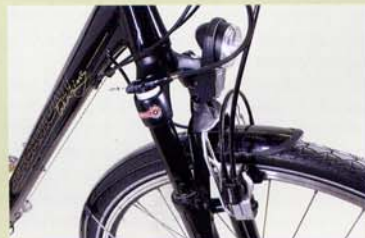
Hochwertig: Fly-IQ-Scheinwerfer, Magura-Bremse und Suntour-Federgabel sind echte Oberklassekomponenten.
