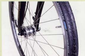
Widerstandsarm: Sowohl die Marathon Racer-Reifen als auch der Shimano-Nabendynamo laufen sehr leicht.
