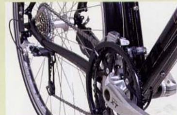
Sortenrein: Eine komplette Shimano XT-Antriebsgruppe sorgt für präzise Funktion und viel Langlebigkeit.
