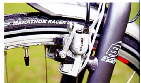
Schnell fahren, sicher bremsen: Leicht rollende Schwalbe Marathon Racer-Reifen und Magura HS-33-Hydraulikbremsen.
