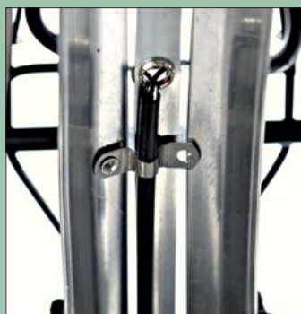
Clevere Kabelführung: Im hinteren Schutzblech verläuft ein flexibles Röhrchen, das das Rücklichtkabel schützt.
