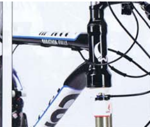
3_Technisch: Das Steuerrohr ist in der Mitte abgedreht und zeigt die Übergänge deutlich. Oben sitzt eine 1 1/8-Zoll Lageschale, unten eine im 1.5-Standard.
