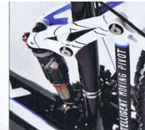
2_Clever: Der Hinterbau des Conway arbeitet mit einem virtuellen Drehpunkt. Das Federbein steht vor dem Sitzrohr, eine senkrechte Strebe gibt dem Hinterbau Stabilität.
