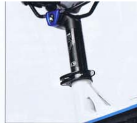
1_Stabil: Ein kleines Verstärkungsblech gibt dem Übergang vom Ober- zum Sitzrohr zusätzliche Stabilität. Oben: die elegante Sattelklemmung der Crankbrothers-Stütze.
