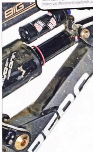
Hydroforming macht's möglich: Bergamont drückte kräftig auf die Ölquetsche, um seinem Rahmen einen zeitgemäßen Look zu verpassen. Unser Urteil: gelungen!
