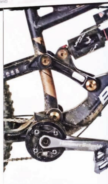
Gut gelagert: Die Oversize-Lager des „Big Air“ drücken zwar auf die Waage und lassen das Rahmengewicht nach oben schnellen, dafür scheinen sie für die Ewigkeit gemacht.
