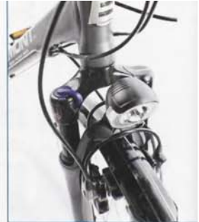
Gut: LED-Scheinwerfer, Magura Hydraulikbremsen, Federgabel mit Blockierheb
