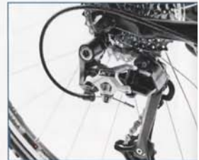
Bekannt als robust und präzise: Das Shimano XT Schaltwerk ist aus dem Mountainbike-Regal
