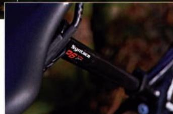
HiFlex mit 27,2 Millimeter Durchmesser. Mehr Komfort beim Hardtail geht nur noch in Kombination mit einem entsprechenden Sattel.
