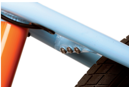
links: Cleane Optik 1: Schutzblechbefestigung unter dem Quersteg
