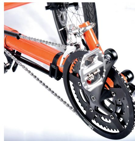
Das Hauptrohr zum Tretlager kann mittels Schnellpanner einfach in der Länge verstellt werden.
