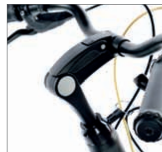
Mit diesem Vorbau kann man Lenker und Neigewinkel werkzeuglos verstellen.
