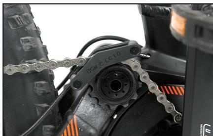
Mit Umlenkrolle und Kettenfuhrung ...
