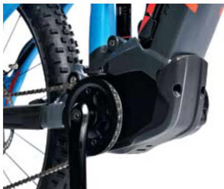
Schaltung inklusive: Panasonic-Motor mit zweistufigem Getriebe und Schlagschutz.
