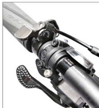
Praktisch: Hebel zum Gabel-Blockieren/-Entriegeln (oben links)
